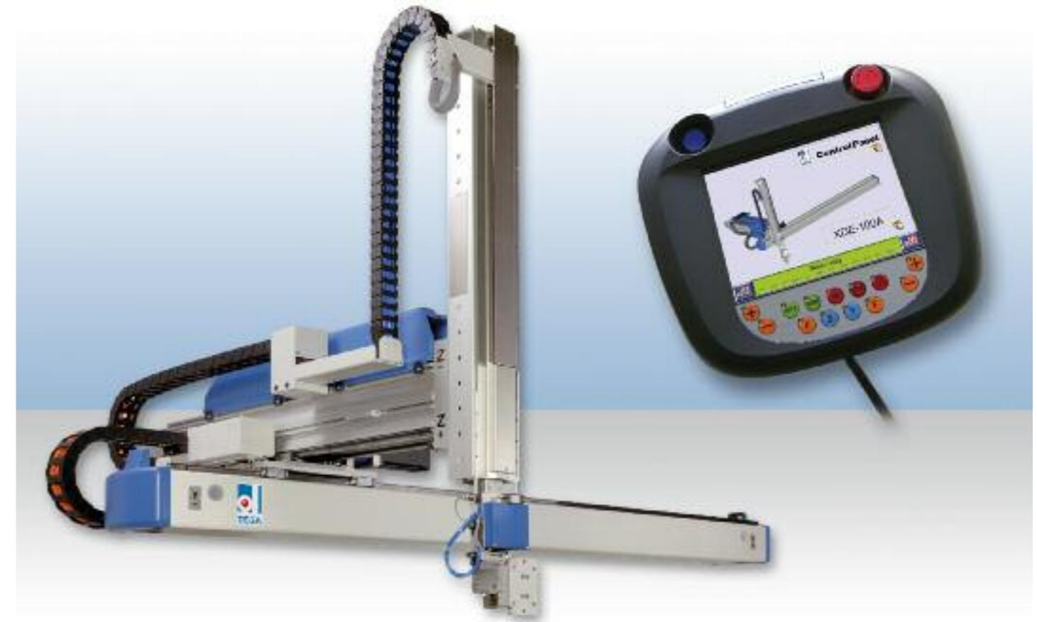
Il controllo è garantito dalla affidabilità della elettronica B&R, semplice e pratico nella programmazione, con schermo 8,4 " VGA Touch Screen a Colori, impugnatura ergonomica destra e sinistra, pulsante di sicurezza a tre posizioni, azionamenti digitali con controllo di velocità e posizione integrato adatto al controllo di motori Brushless Rotativi e Lineari.
