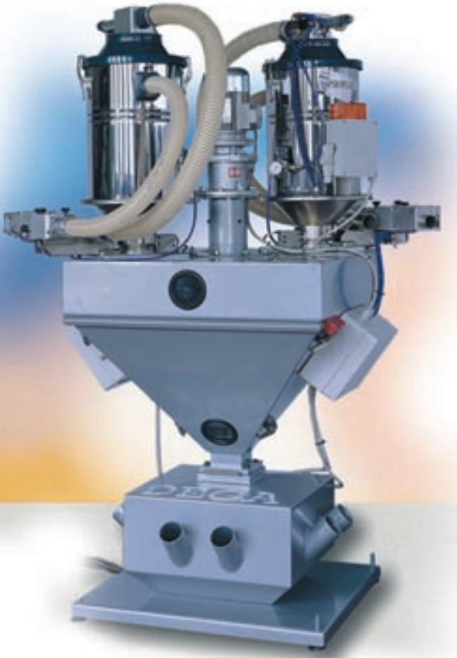
IL software di controllo e gestione dell'impianto di trasporto, è interfacciato con il software dell'impianto gravimetrico. Ad ogni richiesta di materiale il gravimetrico produce la ricetta e la distribuisce ai contenitori di stoccaggio o direttamente alla macchina che ne ha fatto richiesta.
