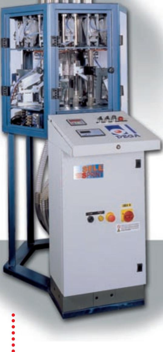
La completa automazione dell'impianto si raggiungere interponendo tra le macchine utilizzatrici e la zona di prelievo la valvola di selezione **SELE SPRINT** nelle due versioni 12+12 o 24+24 stazioni.
