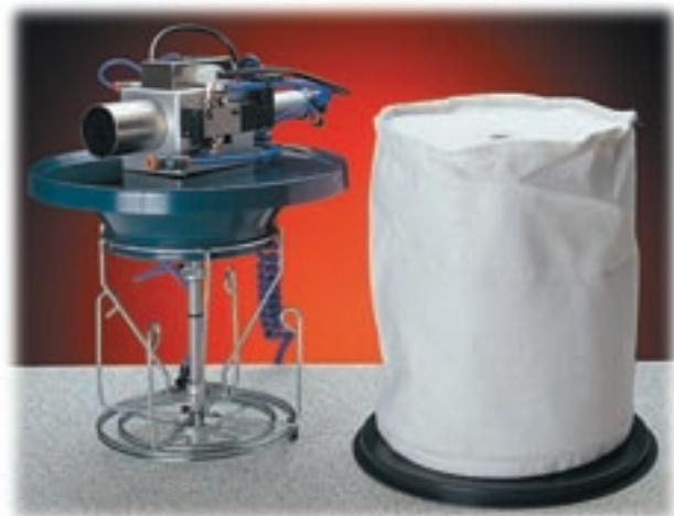
Testata con filtro in poliestere e pulizia mediante battifiltro.
