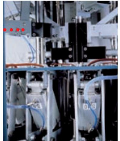
Les mâchoires de raccordement ont également la fonction de vanne de nettoyage des conduits.
