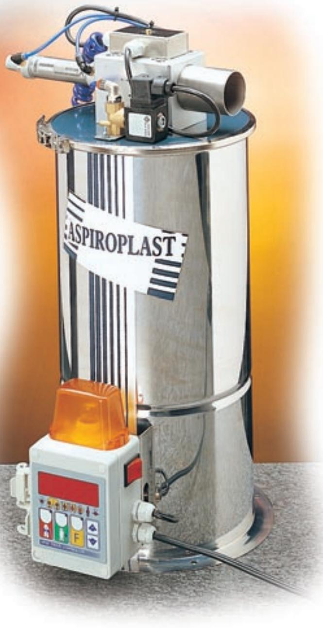
Ciclone per la raccolta del granulo sulla tramoggia. Scelto fra le 3 grandezze per adeguarsi alle dimensioni dell'impianto e alle condizioni di installazione.
