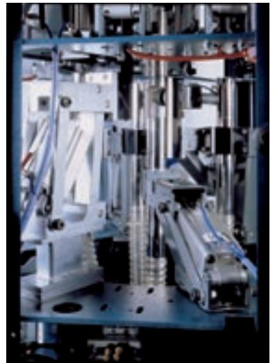
La conexión entre la zona de toma y la de transporte se consigue superponiendo las dos tuberías mediante simples gatos neumáticos, por lo que no hay partes en contacto con el material, que trabajan en fricción o en rotación.
