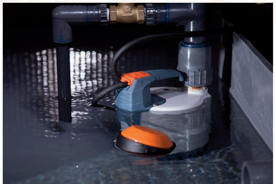
El circuito de humectación de los paneles de celulosa está construido completamente en material no ferroso con tinas de fibra de vidrio para la recolección del exceso agua de humectación.
