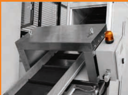
Metal-Detector a Tunnel o a Piastra sottotela, installabile su tutti i nastri.
