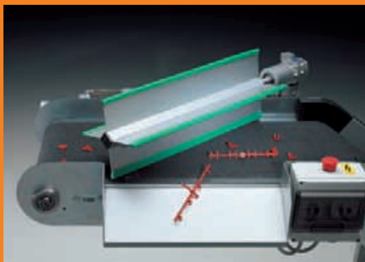
Separatore a palette controrotanti adatto alla maggior parte delle esigenze di separazione.
